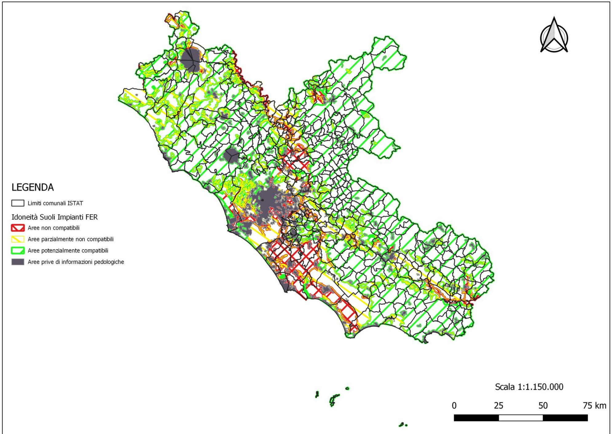
Figure 6 - Idoneità dei suoli ad impianti FER in funzione della Carta della capacità d'uso dei suoli (rif. TAV. B06)
