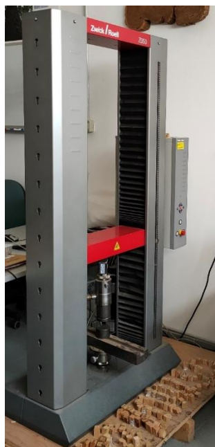
Figura 4 - Macchina prova materiali del laboratorio di Tecnologie del legno del DIBAF (UNITUS).
