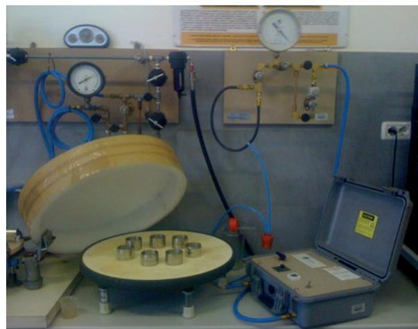
Fig. 9.1 - Piastra in ceramica a suzione, estrattore per suzione e pannello manometrico costituenti il sistema di misura per tensioni tra 0 e 100 kpa
