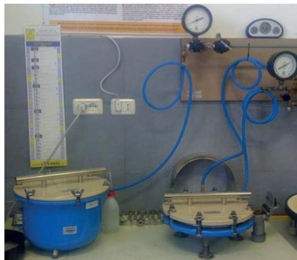
Fig. 9.2 - Apparati di Richards: Pentola e Piastra con sistema di estrazione a pressione utilizzate su dataset campione per confronto metodi di estrazione per punti ad alte tensioni (> 500 kpa)
