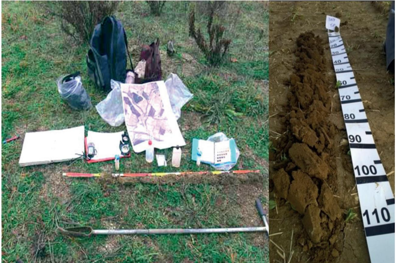
Fig. 8.2 - Esempio di esecuzione trivellata speditiva con trivella manuale olandese
