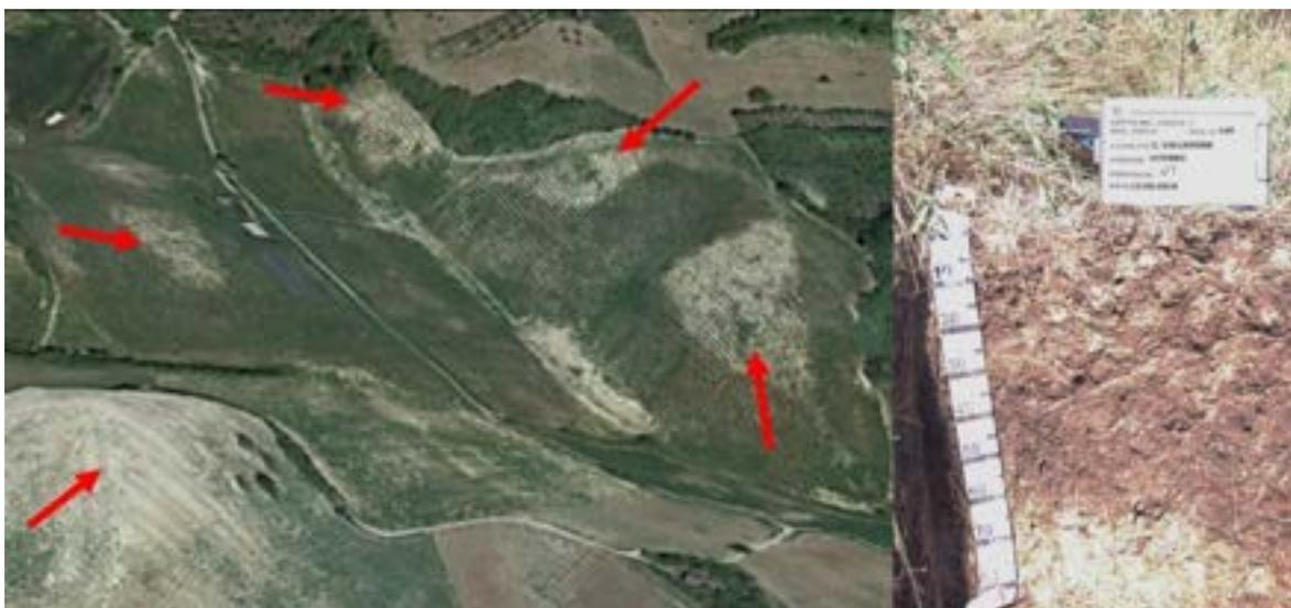
*Figura 8 Esempi di erosione areale accelerata con impianti di colture permanenti – suoli Vallarone, fase tipica (Haplic Calcisols - Loamic). Le frecce in rosso indicano i punti di convessità e/o cambiamenti di pendenza dove le lavorazioni e regolarizzazioni fatte per l'impianto hanno creato aree a forte denudazione con affioramento del substrato argilloso-limoso.*
