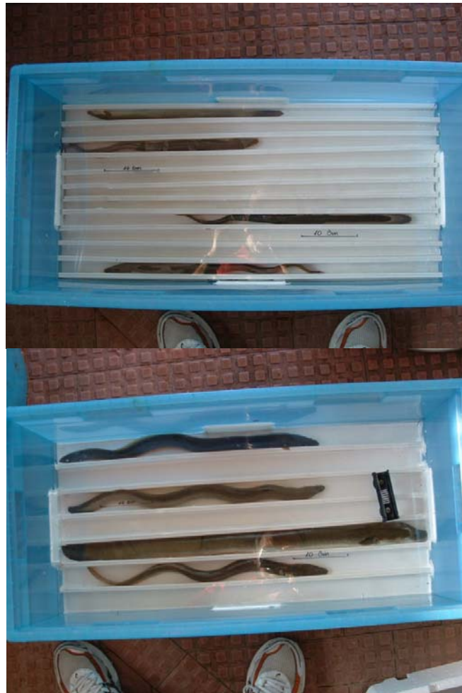
Figura 6 Cassetta in plastica con canaline di larghezza differente, applicate con silicone sul fondo del contenitore. Il dispositivo è dotato di coperchio in lastra di plexiglas trasparente con riferimenti metrici segnati.
