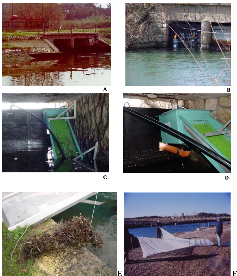
Figura 1: Esempi di dispositivi per il monitoraggio del reclutamento: A-D scala di monta, E: fascina, F: bertovello da ceche
