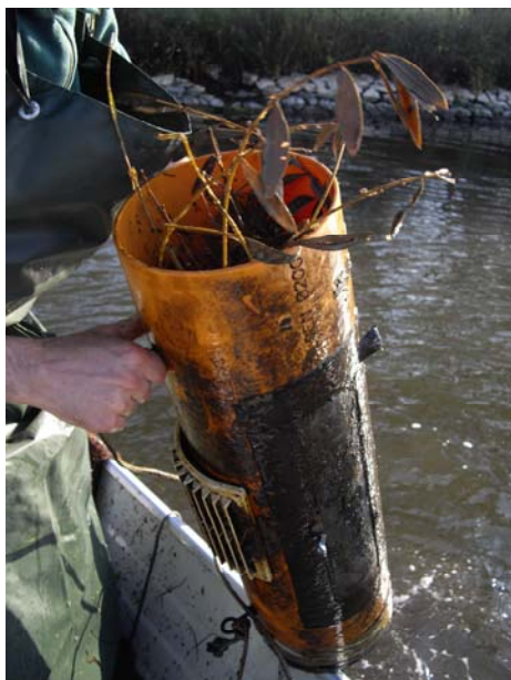
Figura 2: Esempio di dispositivo per il monitoraggio del reclutamento: substrato realizzato con tubo in PVC
