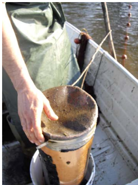
Figura 2: Esempio di dispositivo per il monitoraggio del reclutamento: substrato realizzato con tubo in PVC
