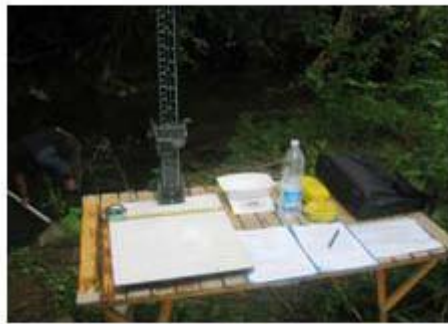
Figura 4: Equipaggiamento per rilievo parametri biometrici e riprese fotografiche (in primo piano uno stativo provvisto di dispositivo di ancoraggio della macchina fotografica).
