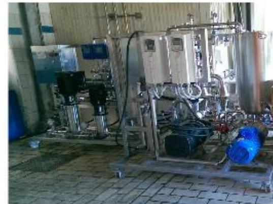
*Recupero acque con sistemi a membrane da acque di processo*
