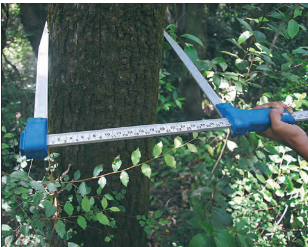
Fig. 5 – Cavalletto dendrometrico; The calliper.
