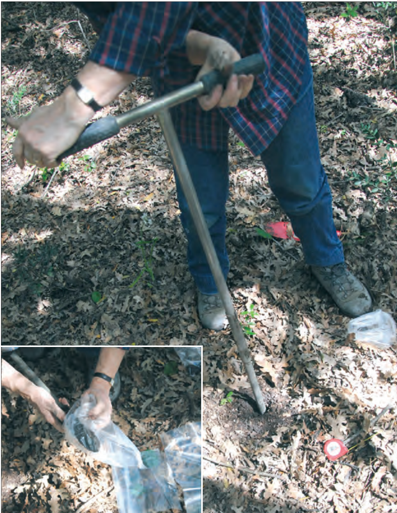
Fig. 1 –Trivella manuale; Soil auger.
