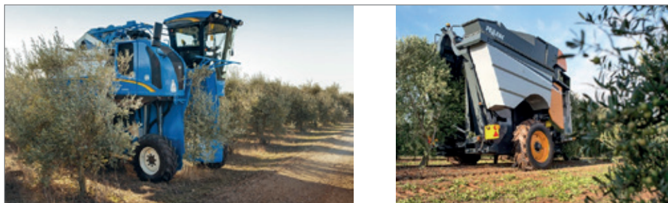
Figura 5 - Macchina semovente scavallatrice New Holland (sinistra) e macchina trainata scavallatrice Pellenc (destra)
