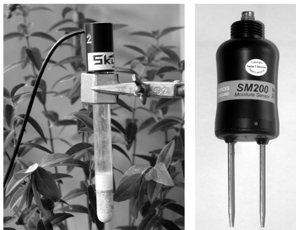
Figura 24 Due esempi di sensori per la determinazione dell'umidità del terreno o del substrato: un micro tensiometro (a sinistra) ed un sensore dielettrico
