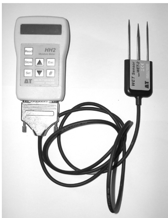
Figura 25 Un sensore WET in grado di misurare la temperatura, il contenuto idrico volumetrico e la salinità del terreno o del substrato
