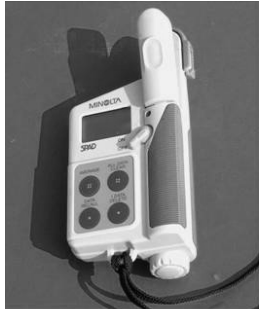
Figura 32 Cropscan a sinistra e SPAD meter a destra. Due strumenti per la stima del fabbisogno nutrizionale delle colture
